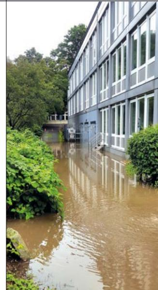
Abb. 2: Die Nutzung von Kellerräumen bedarf einer besonders hohen Aufmerksamkeit. Oft reichen 10 Zentimeter Wasserstand, um den Keller komplett zu fluten. Aufkantungen oder Schutzstöße können bei Wasserständen bis ca. 50 Zentimetern helfen. (Starkregen: Maßnahmen Objektschutz)
