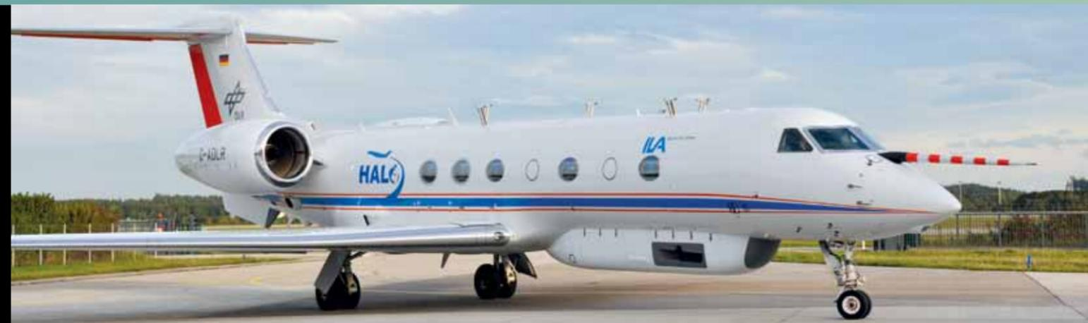
Abb. 4: HALO kehrt von der ersten Mission nach Oberpfaffenhofen zurück. Oben auf dem Flugzeug sieht man die Spurengaseinlässe.
