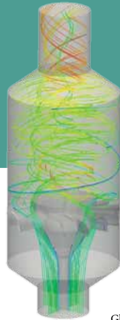
Abb. 2: Stromlinien im Kombiwäscher.
