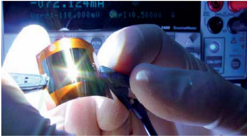
Eine im Labor hergestellte flexible Solarzelle.
