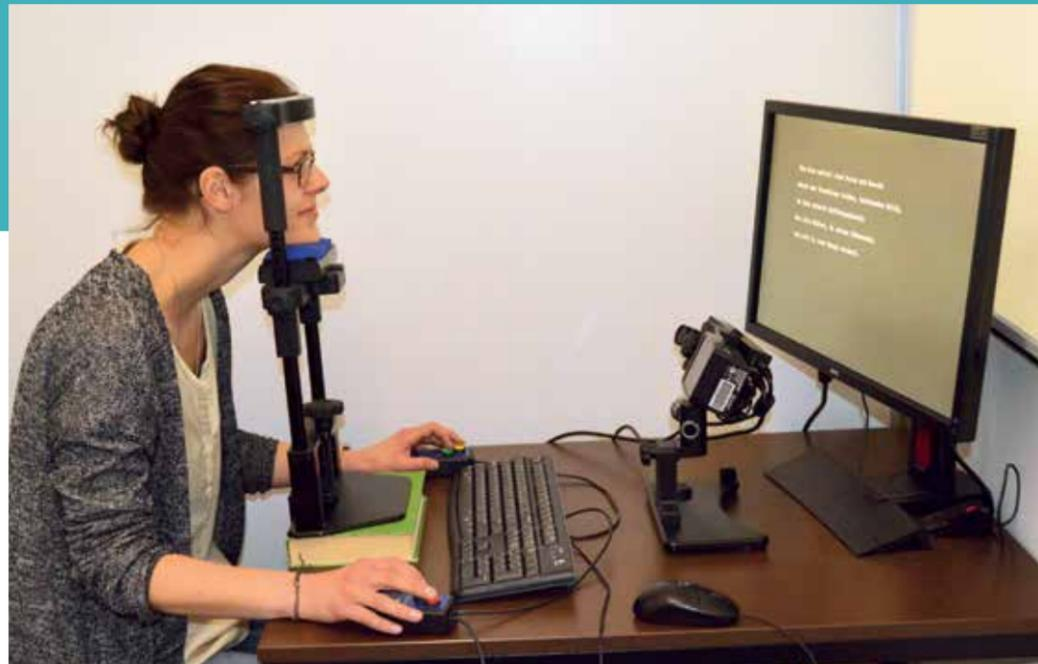
Abb. 3: Typischer Versuchsaufbau bei der Messung von Blickbewegungen im Labor. Die Aufzeichnung erfolgt durch Registrierung von Infrarot-Reflexionen mit einer zeitlichen Auflösung von 1000 Hz und sehr hoher räumlicher Genauigkeit.
