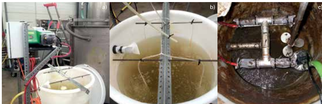
Abb. 6: a) Aufbau des Reaktionsbeckens in der Versuchsstreife, b) das Reaktionsbecken mit geklärtem Abwasser, c) Sicht auf das Filtersystem.
