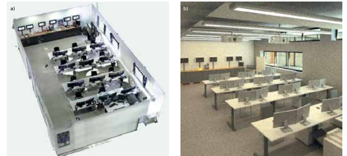
Abb. 3 a) und b): Einsatz von 3-D-Laserscannern zur Generierung von Punktwolken und Bauwerksdatenmodellen.
