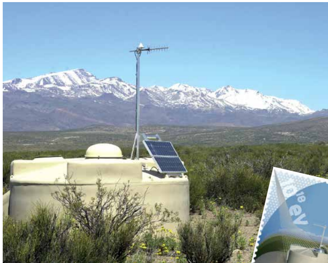
Abb. 1a: Nachweisdetektor des Pierre-Auger-Observatoriums in der Pampa Amarilla, Argentinien.
