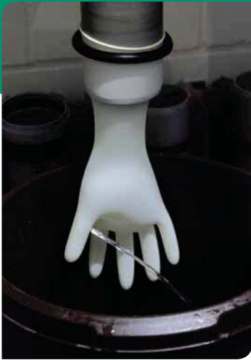
Abb. 2: Handschuh im Wasserhaltetest: Dort, wo Wasser austritt, ist der Handschuh perforiert.
