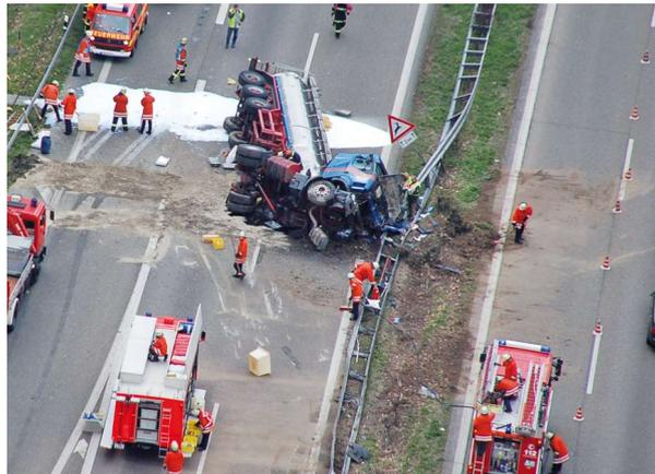
Abb. 6: Beispiel eines Durchbruchunfalls mit Gefahrgut.
