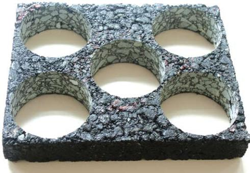
Abb. 1: Asphaltplatte, der Bohrkern entnommen wurden.
