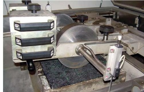
» Zur Beurteilung des Haftverhaltens zwischen Gestein und Bindemittel wird das in Wuppertal entwickelte Verfahren nach NÖSLER angewendet. Die Steifigkeit von Marshallprobekörpern wird bestimmt, und zwar vor und nach einer definierten Wasserlagerung. Ist die Steifigkeitsabnahme nach der Wasserlagerung  $> 30\%$ , ist der haftkritische Grenzwert überschritten.
