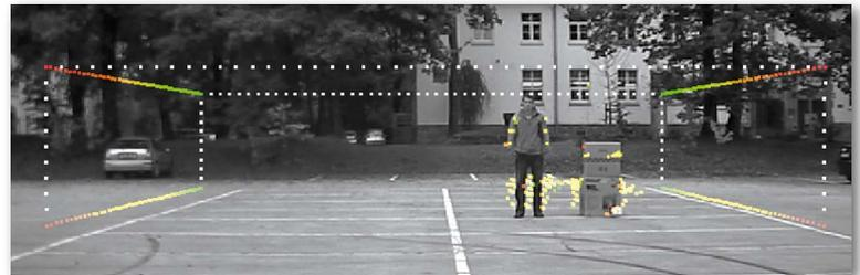
Abb. 11: In das Bild rückprojizierte Voxelbeiträge (falls über einem Schwellwert liegend). Die Farbe codiert nicht die Intensität, sondern den Tiefenwert. Die Berandung des Voxelquaders ist zur Orientierung eingeblendet.
